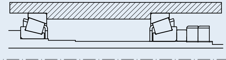
(d) Position preload without spacers
